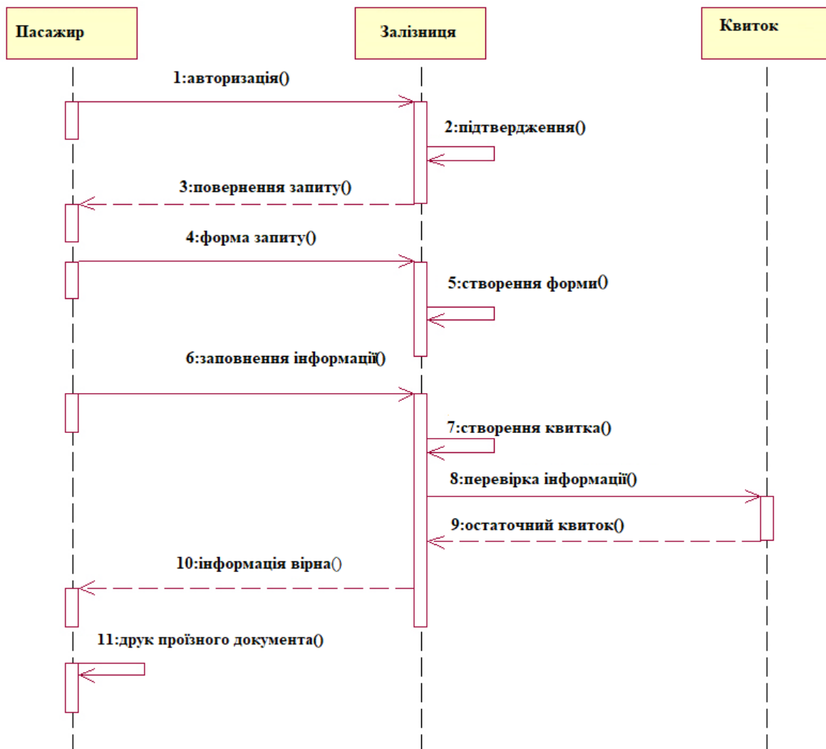
Рисунок 18 – Діаграма активностей для формалізації процесу бронювання проїзного документа на пасажирський поїзд
