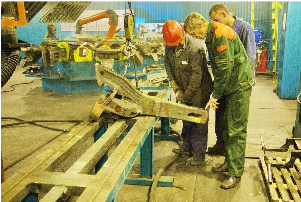
Рис. 1.7. Відділення з ремонту автозчіпних приладів вагонів
