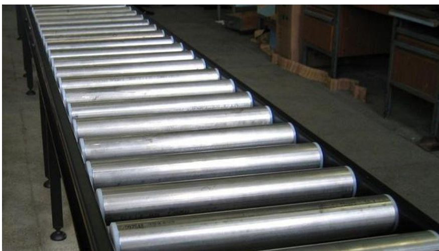
Рис. 2.6. Роликові конвеєри для ремонту окремих вузлів вагонів
