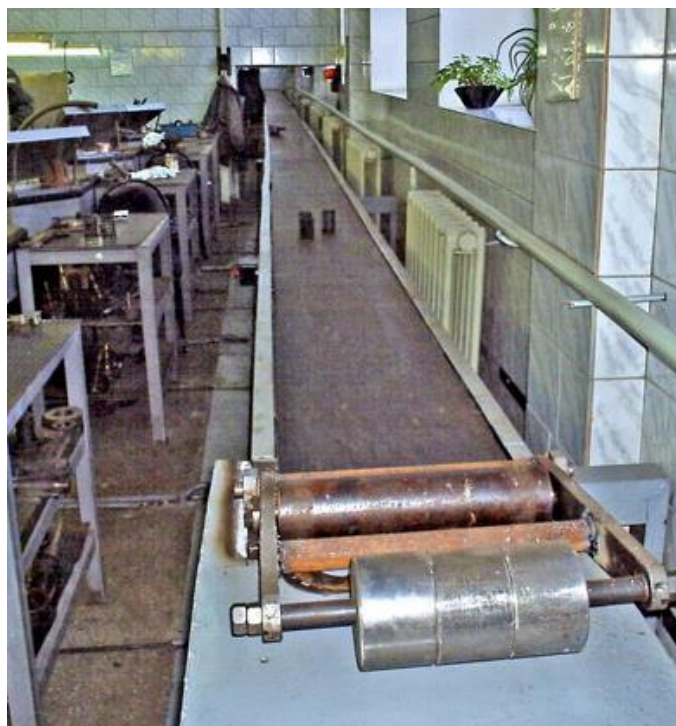
Рис. 2.4. Поточкова лінія з ремонту гальмового обладнання
