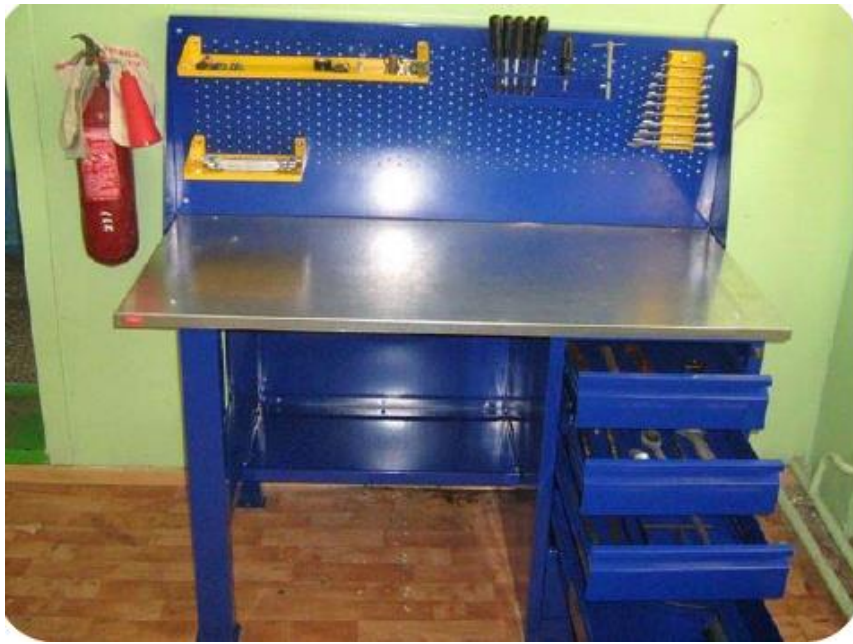
Рис. 5.9. Раціональне організаційне оснащення робочого місця
