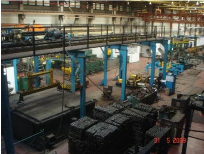
Рис. 2.5. Потокова лінія для ремонту візків вантажних вагонів
