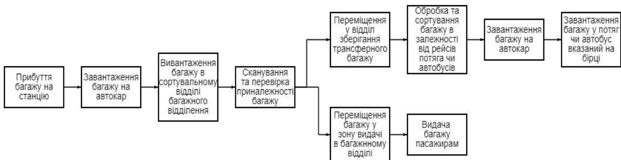
Рис. 1. Структурно-логічна схема обробки багажу при прибутті на станцію пересадки, у випадку сканування та перевірки багажу у багажному відділі
