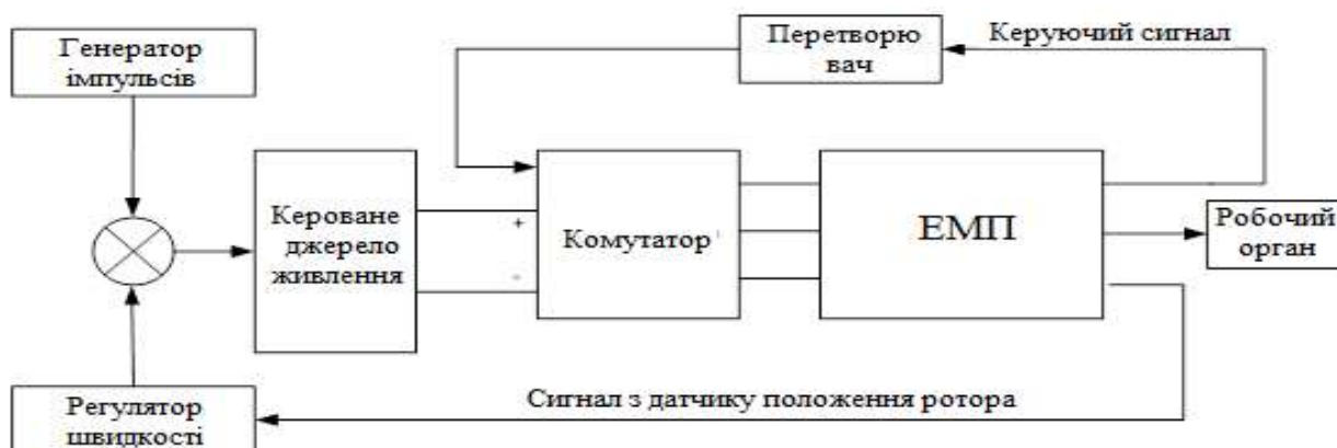
Рис. Структурна схема керування стрілочним електродвигуном
