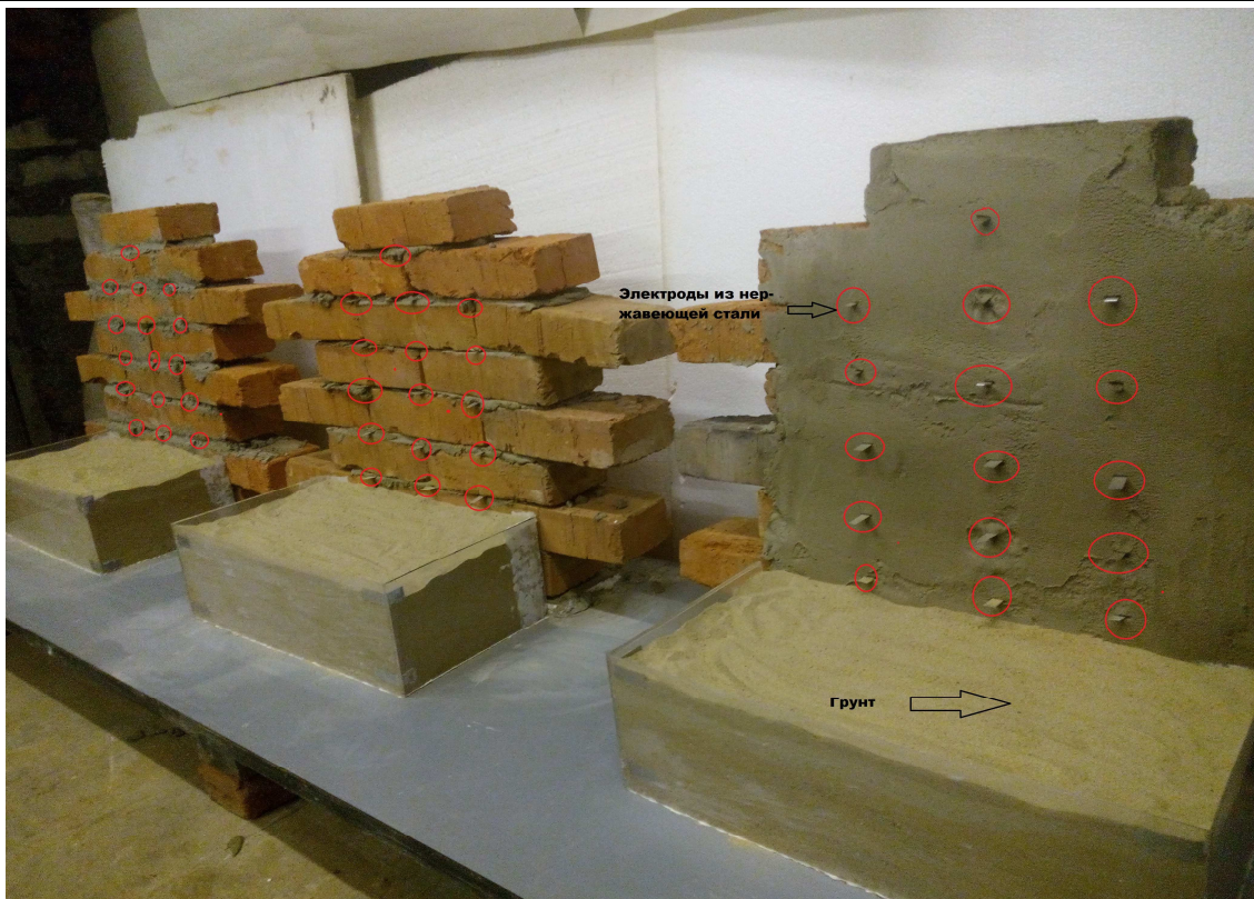
Рис. 2 Фотоснимок моделей фрагментов зданий из кирпичной кладки в лабораторных условиях
