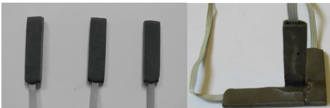
**Рисунок 1 – Внешний вид глубинных датчиков**
