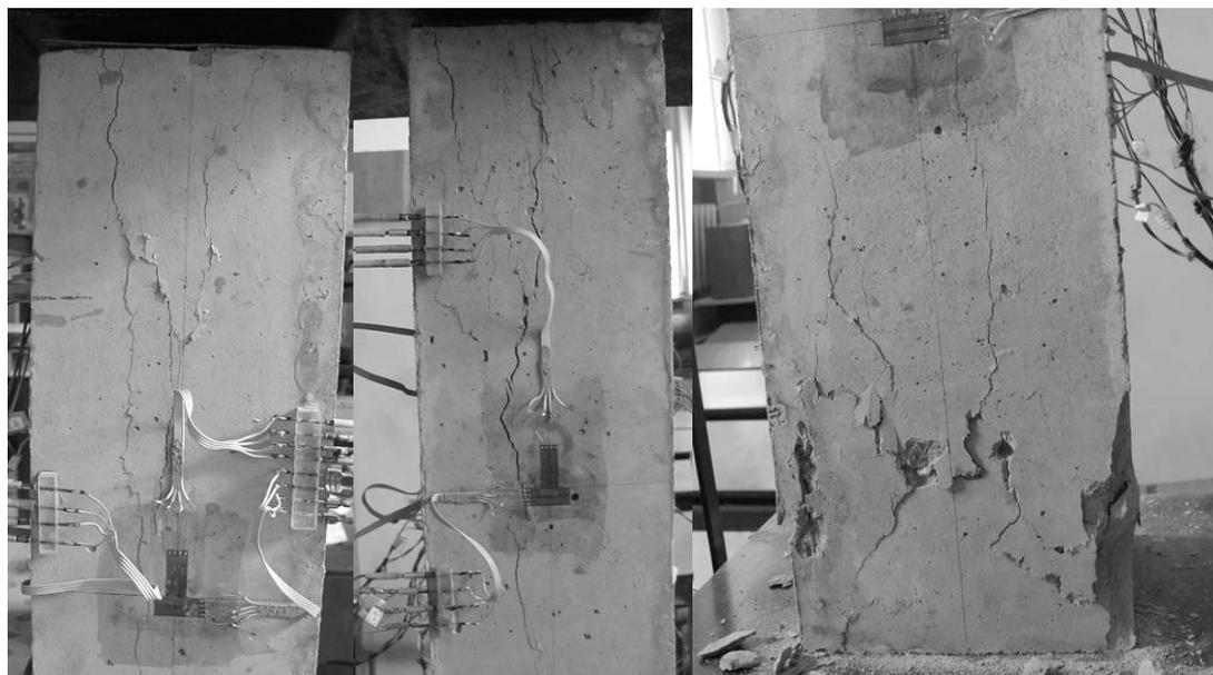
**Рисунок 4 – Вид бетонных призм после испытания**
