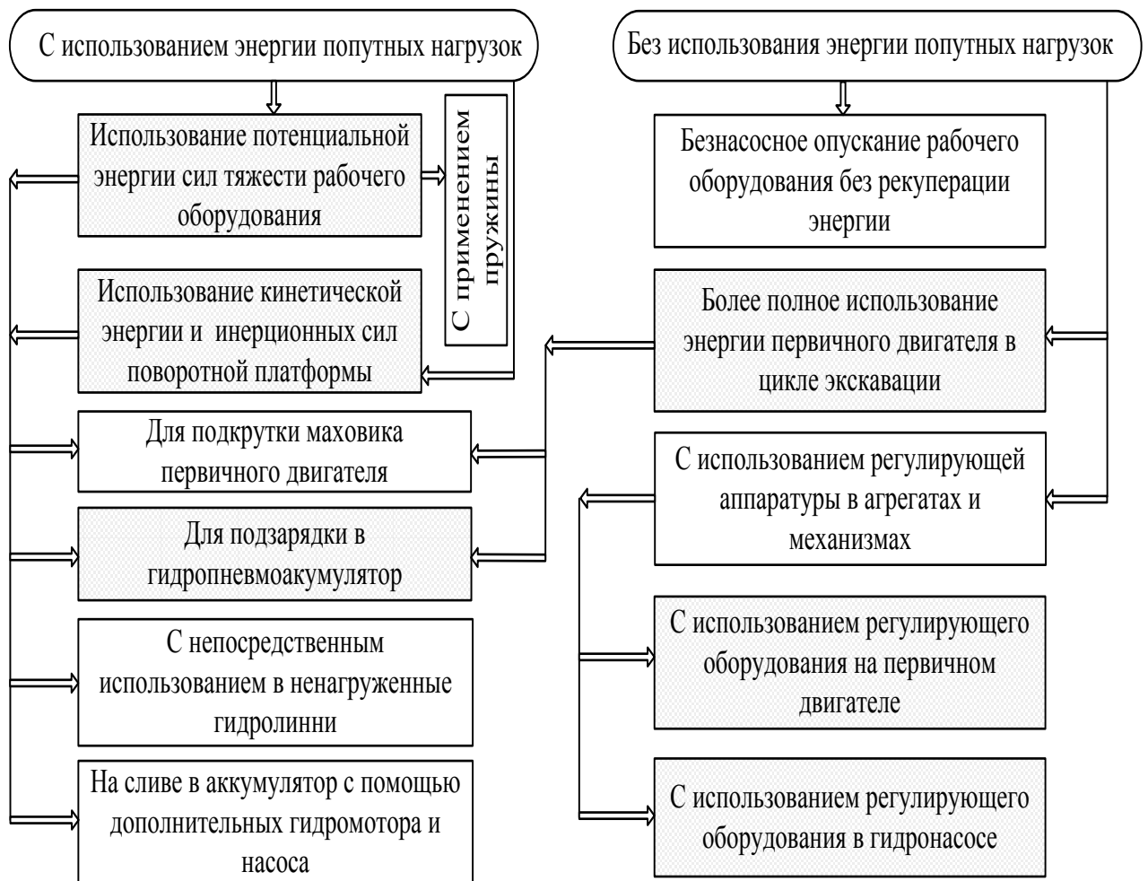
Рис. 3. Класифікація енергозберігаючих рішень [3], призначених для застосування в гідросистемах одноковшевого екскаватора
