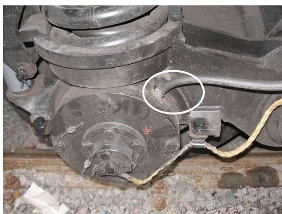
Рисунок 4.1 – Буксовий вузол із датчиком СКНБ-К та сполучна коробка візка
