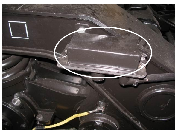
Рисунок 4.1 – Буксовий вузол із датчиком СКНБ-К та сполучна коробка візка
