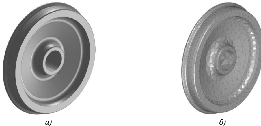
Рис. 3. Суцільнокатане колесо візка вантажного вагона а) просторова модель; б) скінчено-елементна модель
