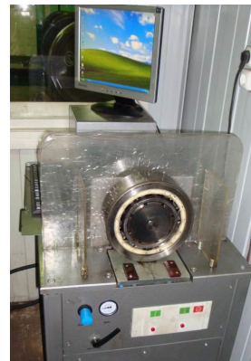
Рис. 3. Стенд СВ-01В для вібродіагностування підшипників кочення
