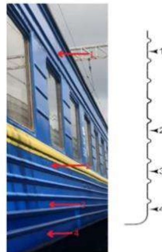
Рис. 5. Схема проведення вимірювань обшивки бокової стіни
