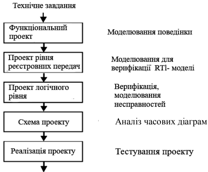
Рисунок 3.1 – Основні етапи спадного проектування цифрових систем
