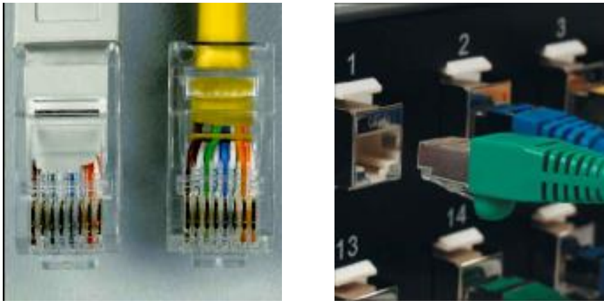
Рисунок 11 – Рознімач RJ-45 і порт підключення рознімача
