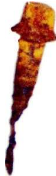
Рис. 3.61. Електрокорозійні пошкодження елементів верхньої будови колії: a – рейок і рейкових скріплень у старому Бескидському тунелі Львівської залізниці; б – підкладок рейкових скріплень у Сухарному тунелі Придніпровської залізниці; в – шурупу рейкового кріплення метрополітену
