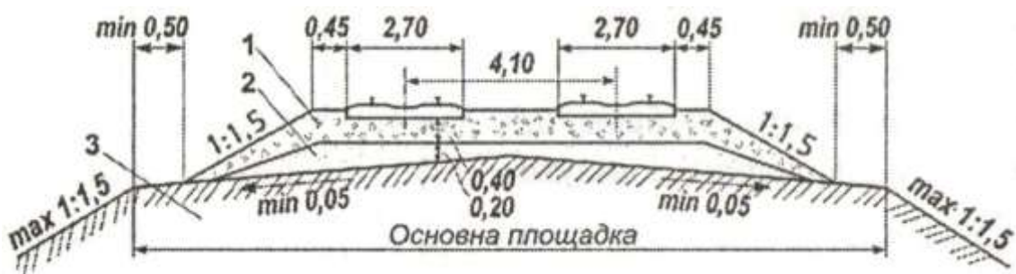
Рис. 1.8. Конструкція верхньої частини земляного полотна зі зв'язних ґрунтів з підбаластовою піщаною подушкою для одноколійних ( а ) і двоколійних ( б ) ділянок: 1 – щебневий шар; 2 – піщана подушка; 3 – тіло земляного полотна з глинистих ґрунтів
