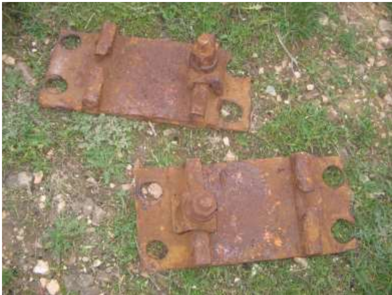
Рис. 3.61. Електрокорозійні пошкодження елементів верхньої будови колії: a – рейок і рейкових скріплень у старому Бескидському тунелі Львівської залізниці; б – підкладок рейкових скріплень у Сухарному тунелі Придніпровської залізниці; в – шурупу рейкового кріплення метрополітену
