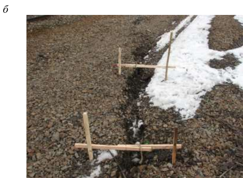
Рис. 4.7. Схема (а) і фото (б) маяків для вимірювання вертикального (1) і горизонтального (1, 2) зміщення головної частини зсуву
