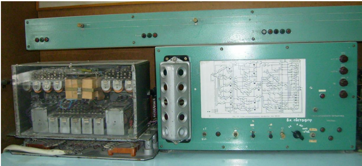
Рисунок 1.6 – Зовнішній вигляд частини дискретного стенда АЛСН без ЕПК та швидкостеміра
