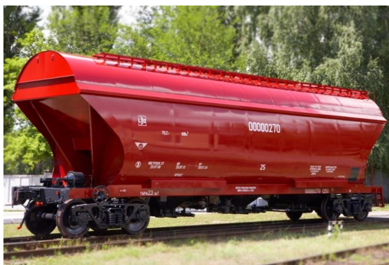
Рисунок 1 – Вагон-хопер для перевезень зерна моделі 19-7016
