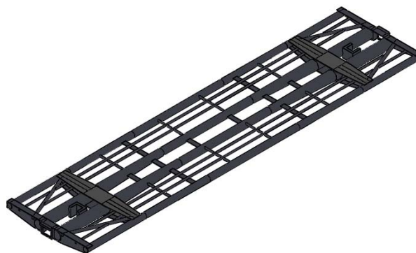
Рис. 4. Просторова геометрична комп'ютерна модель прототипу залізничного вагона-платформи з несучою системою із труб круглих зі змінними перерізами по довжині
