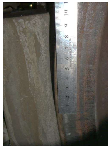
Рисунок 1 — Вимірювання довжини шкідливого зносу гальмової колодки в експлуатації, характерні випадки: а) початкового зносу до 50 мм у нових вагонах з пробігом до 7 тис. км; б) найгірші події, коли довжина шкідливої стертості досягає майже 100 мм
