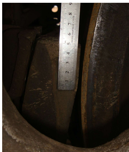
Рисунок 1 — Вимірювання довжини шкідливого зносу гальмової колодки в експлуатації, характерні випадки: а) початкового зносу до 50 мм у нових вагонах з пробігом до 7 тис. км; б) найгірші події, коли довжина шкідливої стертості досягає майже 100 мм
