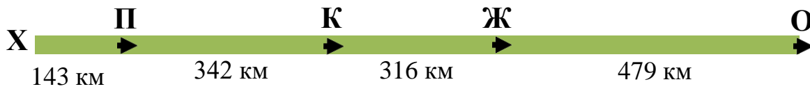
Рис. 7. Курсування контейнерного поїзда по території України від станції X до станції O
