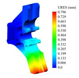
Fig. 13. Shoe displacement
