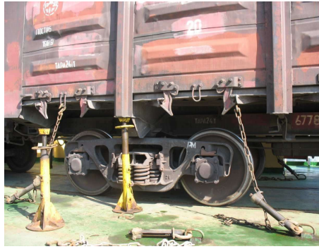
Рисунок 1 - Схема закріплення напіввагона на палубі залізничного порому
