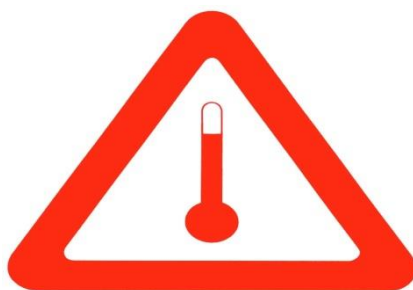
Рис. 1.28. Попереджувальний знак «Підвищена температура»
