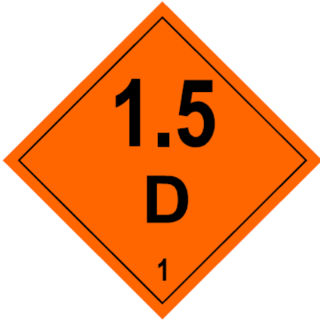
Рис. 1.3. Знак небезпеки для небезпечних вантажів підкласу 1.5
