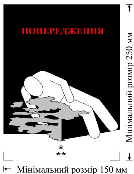
Рис. 2.3. Знак, що попереджає про охолодження/кондиціонування вагонів і контейнерів
