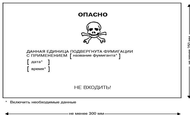
Рис. 1.29. Попереджувальний знак для профумігованої вантажної транспортної одиниці
