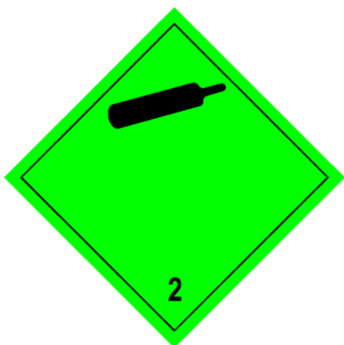
Рис. 1.7. Знак небезпеки для небезпечних вантажів підкласу 2.2
