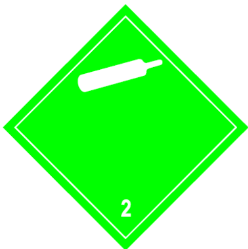
Рис. 1.8. Знак небезпеки для небезпечних вантажів підкласу 2.2
