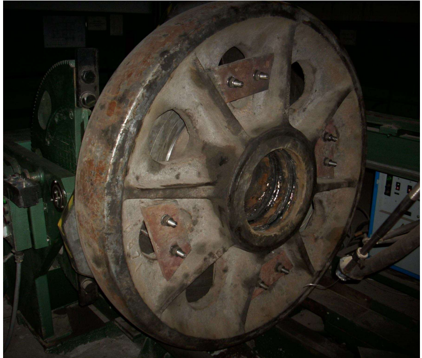
Рисунок 6 – Наплавка напорно натяжного колеса экскаватора на установке РМ УН-5
