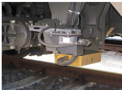
Рисунок 10.1 – Зчитувач для прийому кодових посилок від баліз, що встановлюється під днищем поїзда на рівні 21 см над головою рейки
