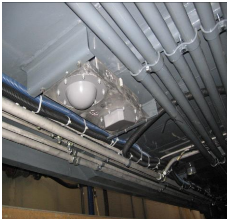
Рисунок 10.5 – Доплерівська радарна одометрична система, встановлена на днищі залізничного транспортного засобу
