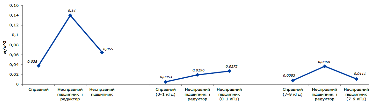
Рис. 3. СКЗ редукторів із різним технічним станом і різних частотних діапазонах
