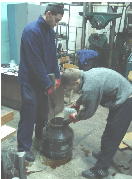
Рис. 3.15. Приготування модифікованого силікатного розчину
