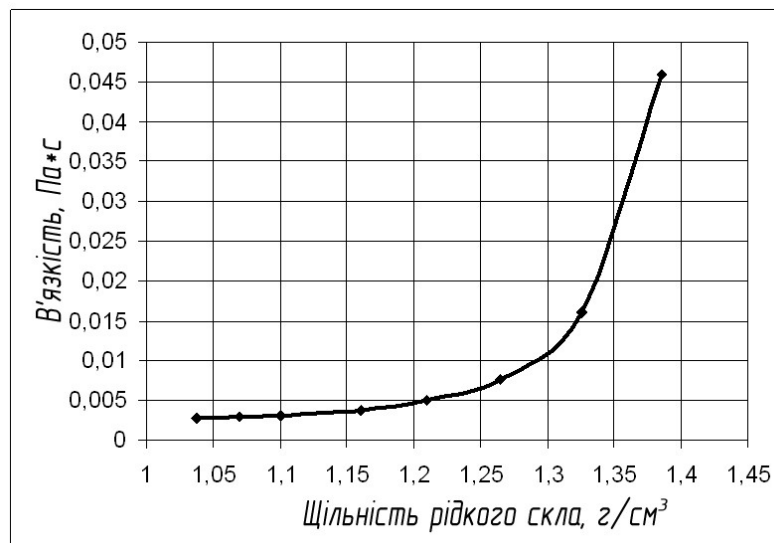
Рис. 1.52. Залежність в'язкості від щільності рідкого скла в інтервалі щільності більше 1,25 г/см 3 (об'ємна частка більше 0,48)
