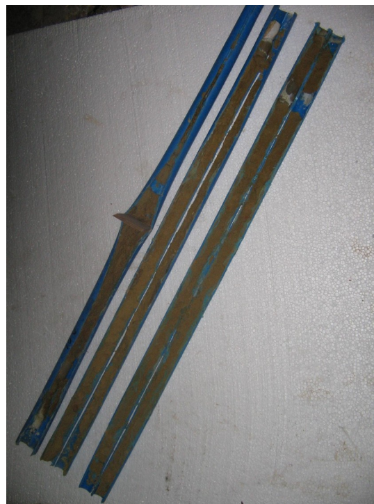
Рис. 1.57. Подовжньо розрізані трубки після нагнітання закріплюючого розчину
