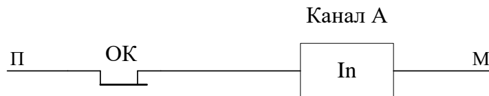
Рисунок 5.6 – Одноканальна схема введення інформації
