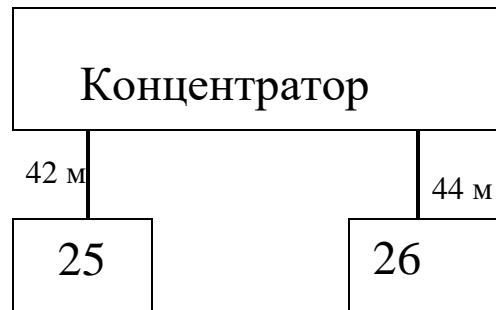
Рисунок 6.4 – Структура сегмента, для якого необхідно розрахувати значення PDV та PVV
