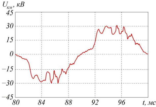
Рис. 10. Діаграма напруги в контактній мережі за запропонованих методів роботи випрямно-інверторного перетворювача
