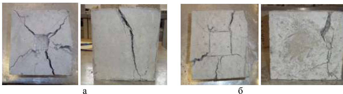
Рис. 1 – Характер руйнування зразка із площею навантаження 30×30 мм (а) та 53×53 мм (б)
