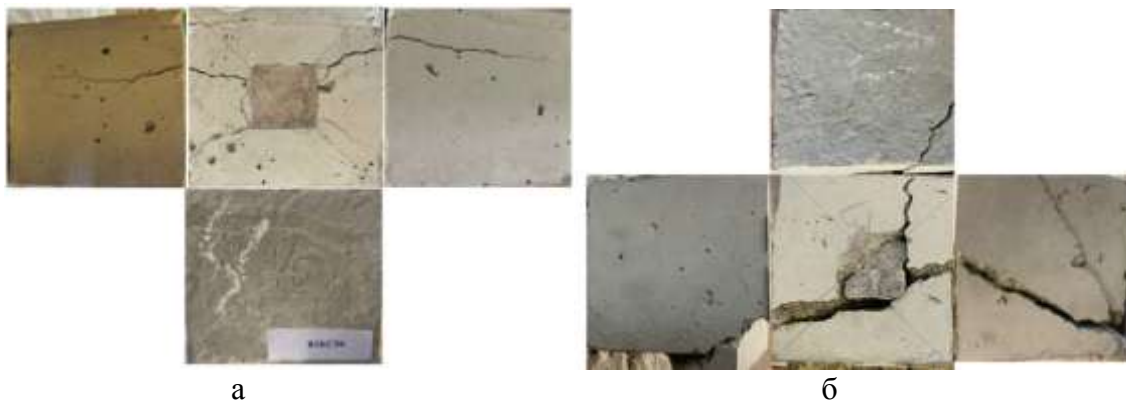
Рис. 3 – Характер руйнування бетонного (а) та фібробетонного (б) куба із площею навантаження 50 \times 50 мм
