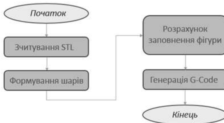
Рис. 1 – Етапи перетворення об'ємної моделі виробів в керуючий код для 3D-принтера
