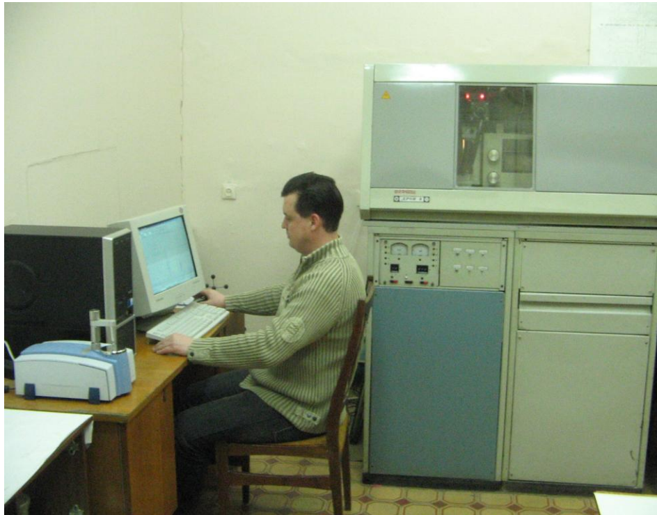
Рис.6.40. Рентгенівський дифрактометр ДРОН-3 модернізований (праворуч) та ІЧ-Фур'є-спектрометр Bruker Alpha (ліворуч) в лабораторії фізико-хімічних досліджень УкрДАЗТ
