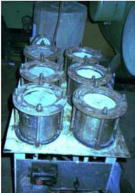
Рис. 6.13. Установа з шістьма гніздами для кріплення зразків: а – вигляд установки; б – один із способів закріплення і герметизації зразка бетону в обоймі заливанням зазора між зразком і обоймою спеціальними мастиками: 1 – зразок бетону; 2 – обойма; 3 – мастика
