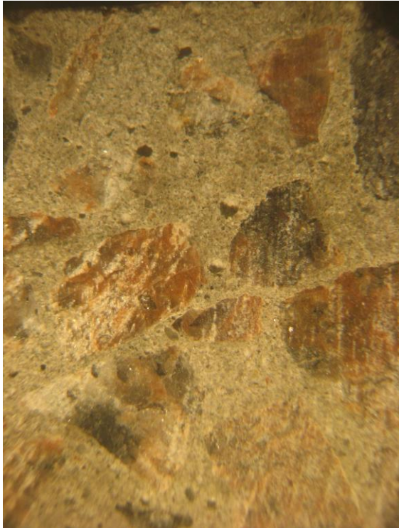
Рис. 6.22. Мікрофотознімки зрізу бетону, обробленого люмінофором: а – у звичайному світлі; б – в ультрафіолетовому світлі; 7,5\times . Бінокулярний мікроскоп МБС-2. Бетон з V/C = 0,42 .
