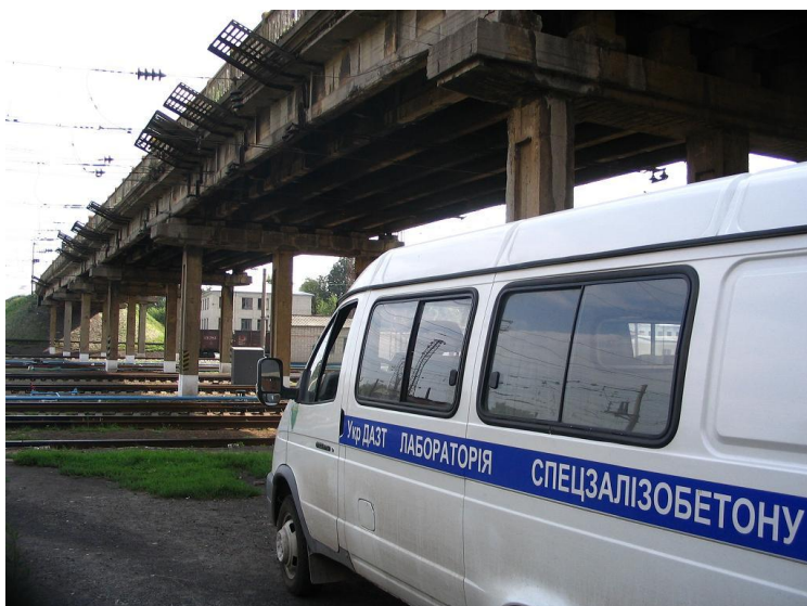
Рис. 3.8. Пересувна лабораторія на базі вантажопасажирського автомобіля «Газель» ГНДЛ підрейкових основ і спецзалізобетону УкрДАЗТ при дослідженні впливу електрокорозії на довговічність і несучу здатність колієпроводу на ст. Лозова Південної залізниці
