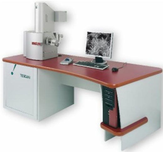
Рис. 6.26. Сучасні моделі електронних мікроскопів – просвічувальних (а, б) і сканувальних (в, г), іноземного (а, в) і вітчизняного (б, г) виробництва: а – JEOL JEM-3100 (Японія); б – SELMI ПЭM-125K (Україна); в – Tescan Mira II (Чехія); г – SELMI PЭM-106И (Україна)
