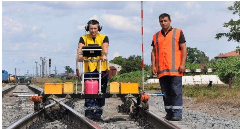
Рис. 1 – Застосування системи дефектоскопії на залізничних рейках
