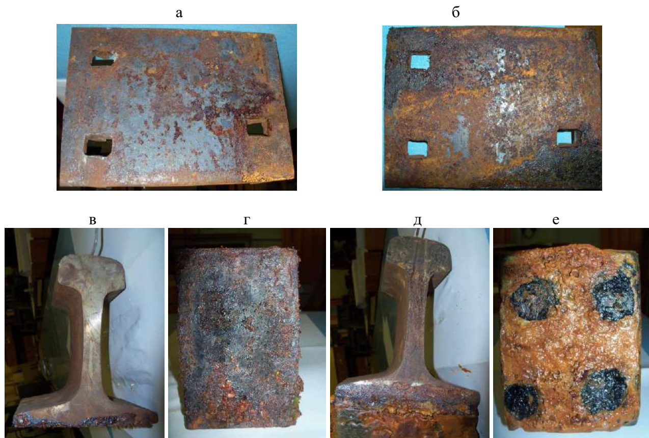
Рис. 10. Зразки, що експонували 1850 год без електричного впливу (тільки у воді) (а) і під електричним впливом (б, в, г): а, б – скріплення Д0, нижня грань підкладки (рис. 9, а); в, г – рейка на деревині (рис. 9, б); а – без електричного впливу (тільки у воді); б – під електричним впливом, рейка на деревині; в, г – рейка на бетоні; а, в – вигляд збоку; б – підшва рейки; г – нижня грань бетону
