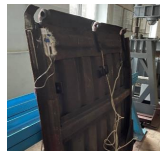
Рис. 3. Розміщення тензорезисторів на кришці люка (нижня частина полотна): a – у зоні розміщення петлі; б – за обв’язкою
