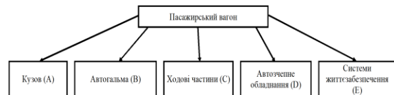
Рис. 1 Схема взаємодії елементів пасажирського вагона
