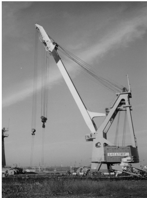
Рисунок 1 – Плавучий кран „Богатир” вантажопід'ємністю 100-300 т
