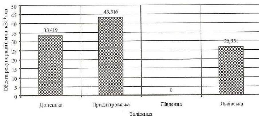
Рис. 2. Повернення енергії рекуперації в тягову мережу по залізницях у 2004 р.
