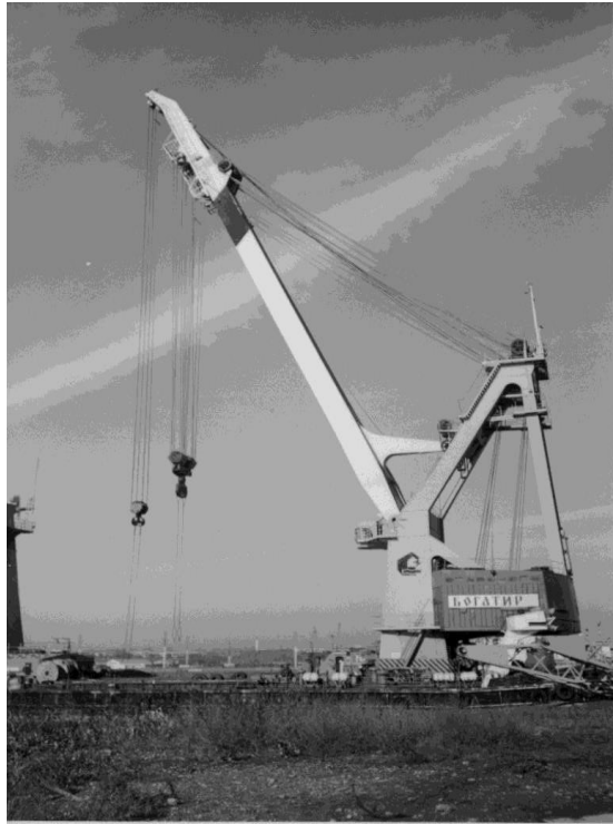
Рисунок 4 – Плавучий кран „Богатир” вантажопід'ємністю 100 та 300 т
