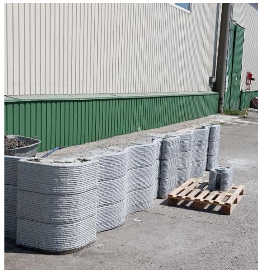
Рис. 4. Друкування експериментальних фрагментів стін на промисловому 3D-принтері компанії ТОВ «Геополімер»
