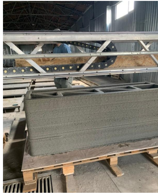
Рис. 4. Друкування експериментальних фрагментів стін на промисловому 3D-принтері компанії ТОВ «Геополімер»
