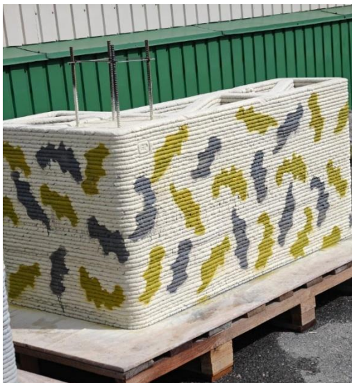
Рис. 4. Друкування експериментальних фрагментів стін на промисловому 3D-принтері компанії ТОВ «Геополімер»
