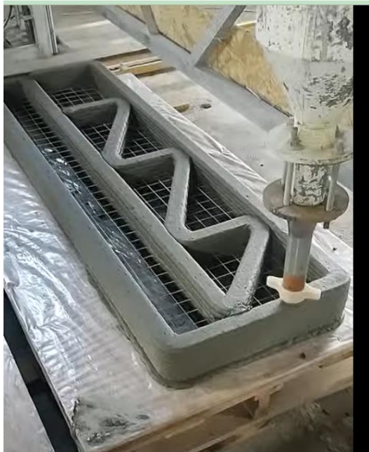
Рис. 4. Друкування експериментальних фрагментів стін на промисловому 3D-принтері компанії ТОВ «Геополімер»
