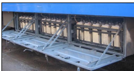
Рис. 1. Розташування типових свинцево-кислотних акумуляторів типу 28L 04 300G у підвагонному акумуляторному ящику
