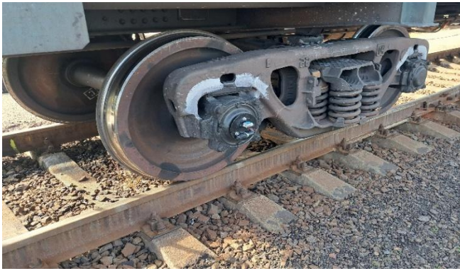
Рис. 2. Зліва IMU-датчик, встановлений на ліву буксу колісної пари; справа GNSS-трекер, встановлений на торцеву стінку напіввагона
