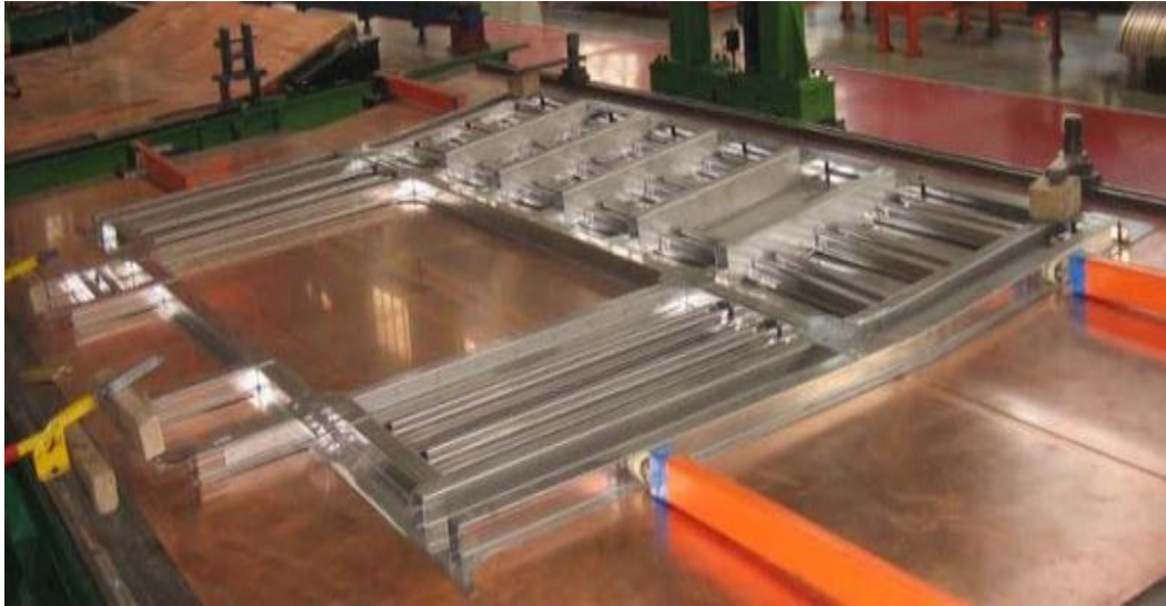
Рис. 3. Панель бічної стіни кузова вагона у стенді зварювання
