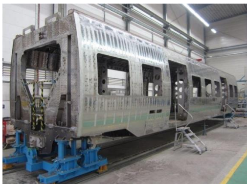
Рис. 8. Кузов пасажирського вагона з елементами конструкції перфорованого перерізу (Alstom)
