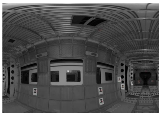
Рис. 8. Кузов пасажирського вагона з елементами конструкції перфорованого перерізу (Alstom)
