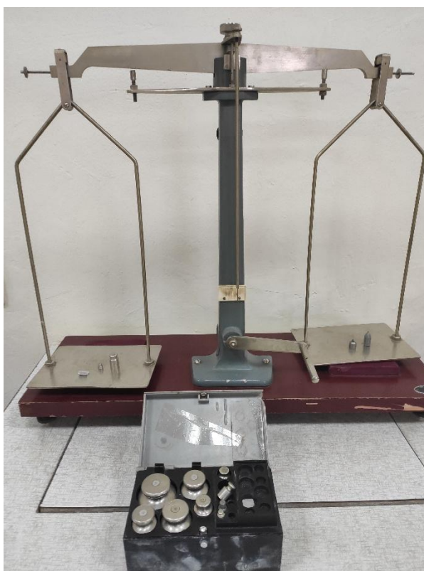
Рисунок 1.5 – Фотозображення технічних ваг для вимірювання мас куль
