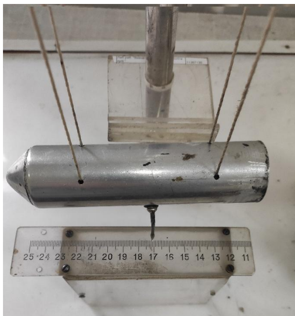
Рисунок 1.4 – Фотозображення лінійки для вимірювання відхилення маятника від положення рівноваги
