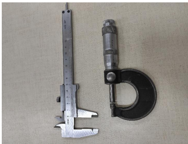
Рисунок 3.4 – Фотозображення штангенциркуля та мікрометра для вимірювання діаметра кулі
