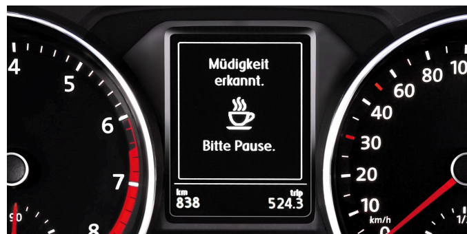
Рис. 4.1. Система розпізнавання втоми на автомобілях Volkswagen
