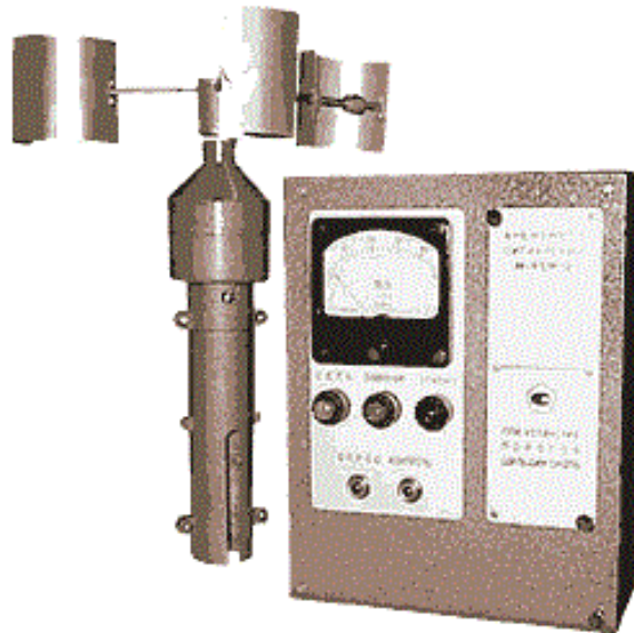
Рис. 1.6. Анемометр крановий М-95 (1985 рік)
