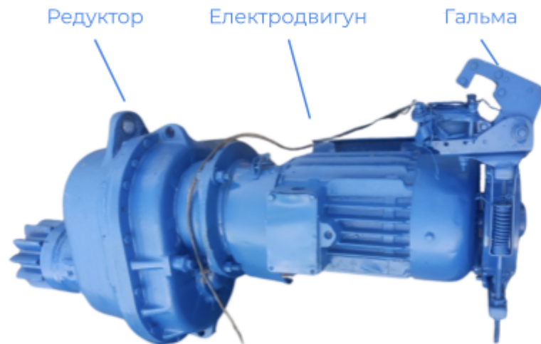
Рис. 2.6. Механізм повороту баштового крана КБ-403
