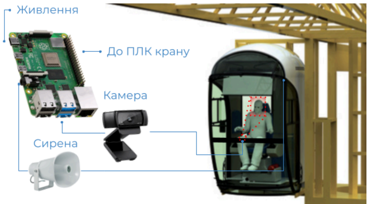
Рис. 4.6. Функціональна схема системи для моніторингу стану оператора баштового крану
