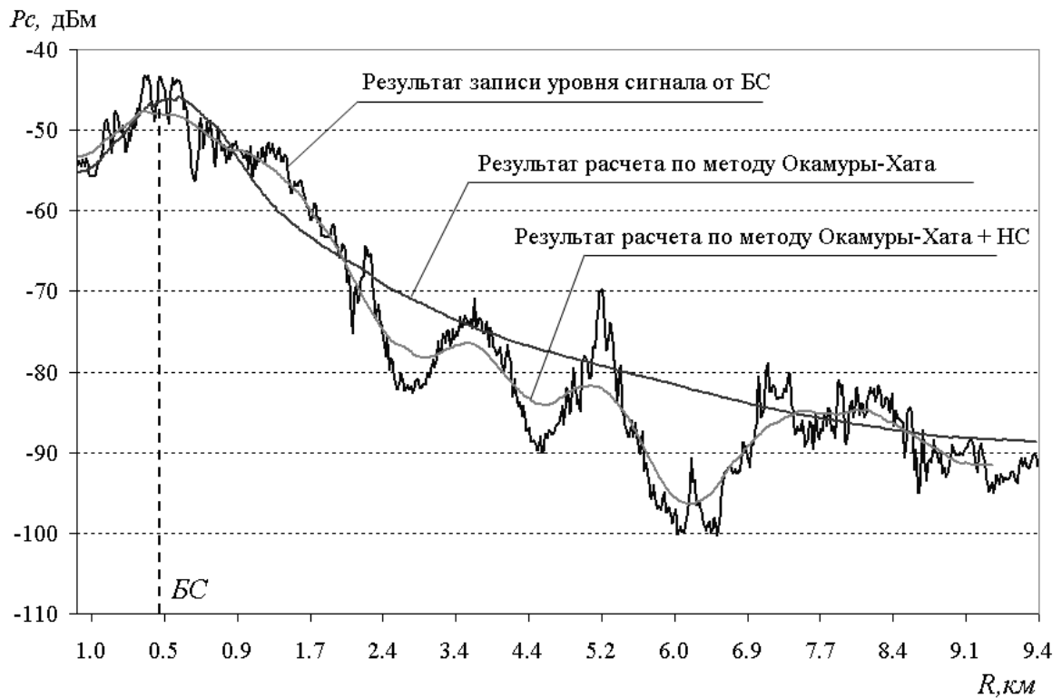
Рис. 3.11 Фрагмент записи уровня сигнала и спрогнозированное значение для данных, не входящих в обучающую последовательность.
