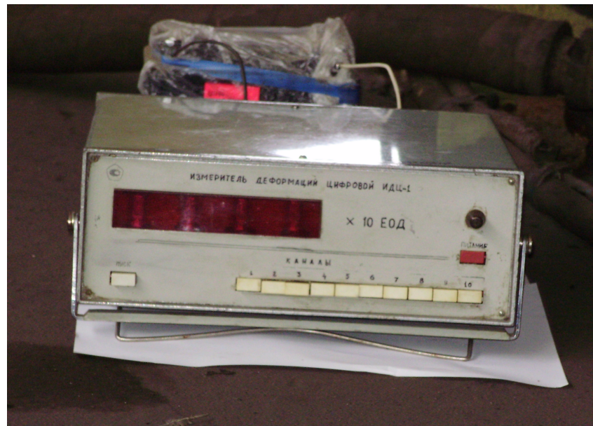
Рисунок 5.2 – Вимірювач деформацій будівельних та машинобудівельних конструкцій ВДЦ – 1
