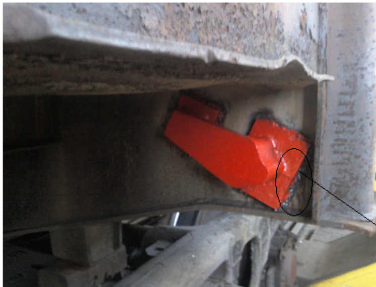
Рисунок 5.11 – Розміщення вузла для закріплення гака ланцюгової стяжки на шворневій балці напіввагону
