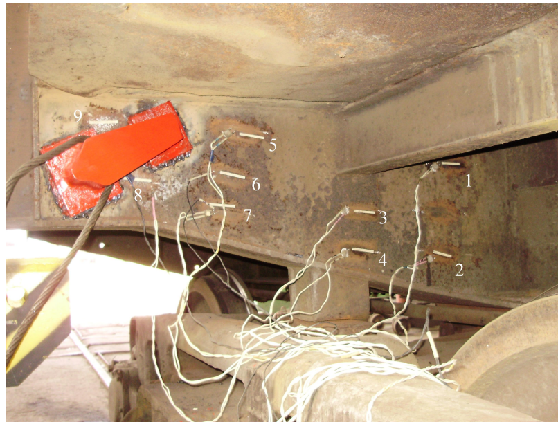
Рисунок 5.13 – Розміщення тензометричних датчиків на вертикальному листі шворневої балки вагону
