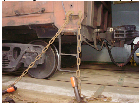
Рисунок 3.12 – Закріплення напіввагона відносно палуби ЗП
