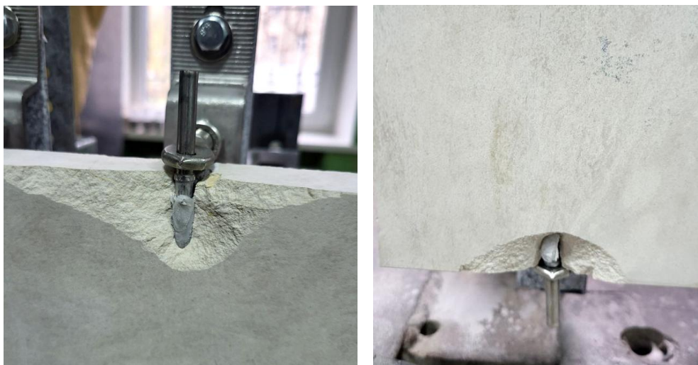
Рис. 9. Руїнація у вузлах кріплення за навантажень ~150 % сейсміки 9
