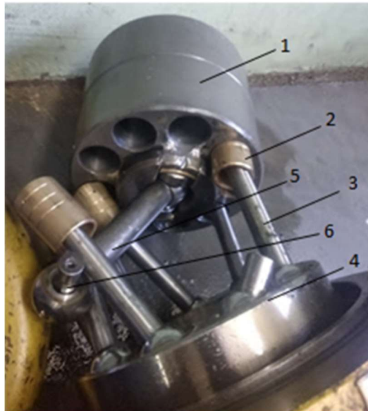
Рис. 2. Елементи циліндро-поршневої групи та шатунно-поршневої групи аксіально-поршневої гідромашини МН250/100:
