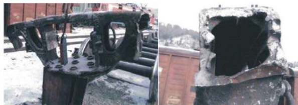
Рис. 2. Злом бокової рами через невиявлену тріщину
