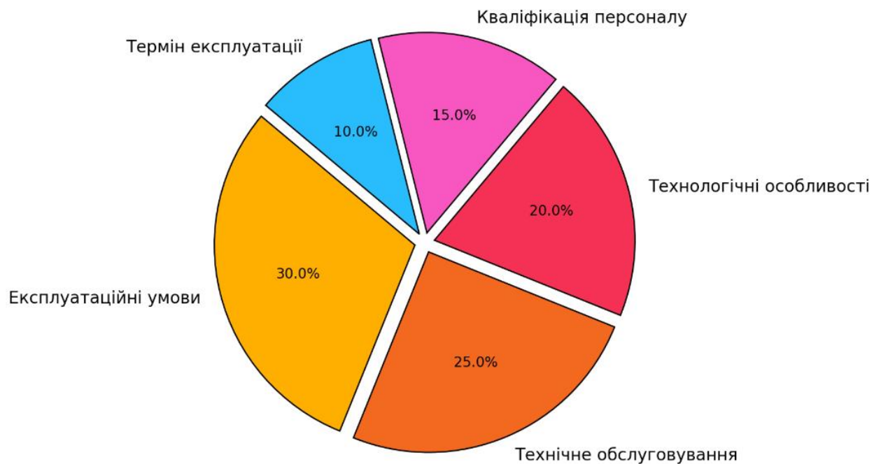
Рис. 1.2. Фактори, що впливають на відмови дизель-генераторних установок тепловозів
