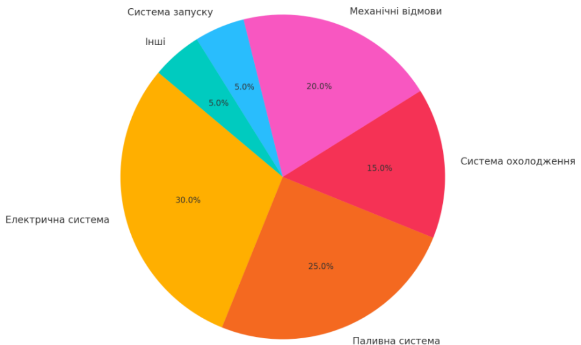
Рис. 1.1. Структура відмов систем дизель-генераторних установок тепловозів
